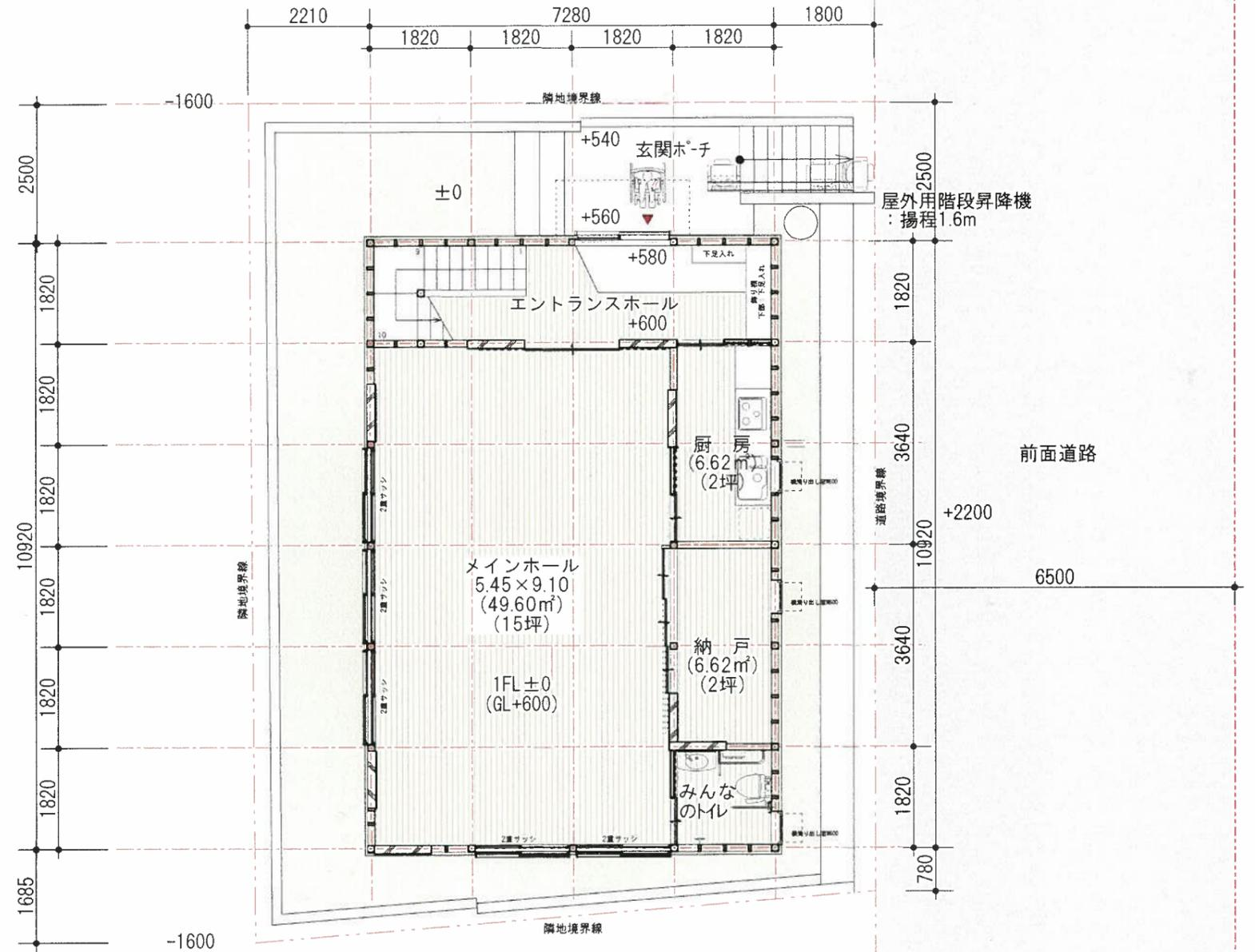
配置図兼1階平面図 S=1/100
